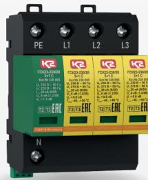
Предназначены для защиты электрооборудования от импульсных перенапряжений, вызванных межоблачными разрядами, коммутацией нагрузок, остаточных бросков напряжения. Не требуют установки УЗИП дополнительных ступеней защиты при расстоянии до защищаемого оборудования не более 5 м по кабелю.
