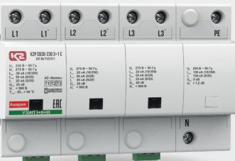
Предназначены для защиты электрооборудования от импульсных перенапряжений, вызванных ударами молнии в систему молниезащиты объекта или линии электропередач, межоблачными разрядами, коммутацией нагрузок, остаточных бросков напряжения. Не требуют установки УЗИП дополнительных ступеней защиты при расстоянии до защищаемого оборудования не более 5 м по кабелю.
